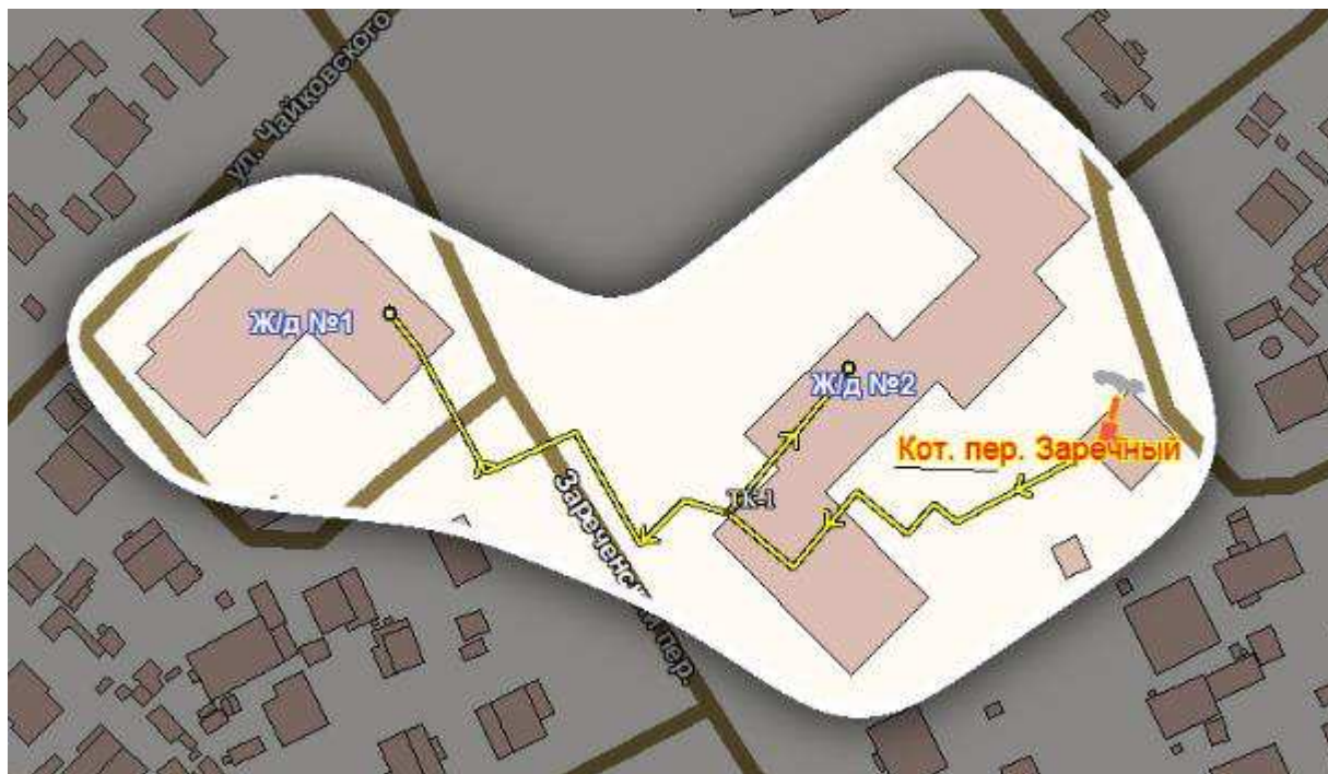
Рисунок 2.20 - Зона действия системы теплоснабжения котельной пер.Зареченский,27
