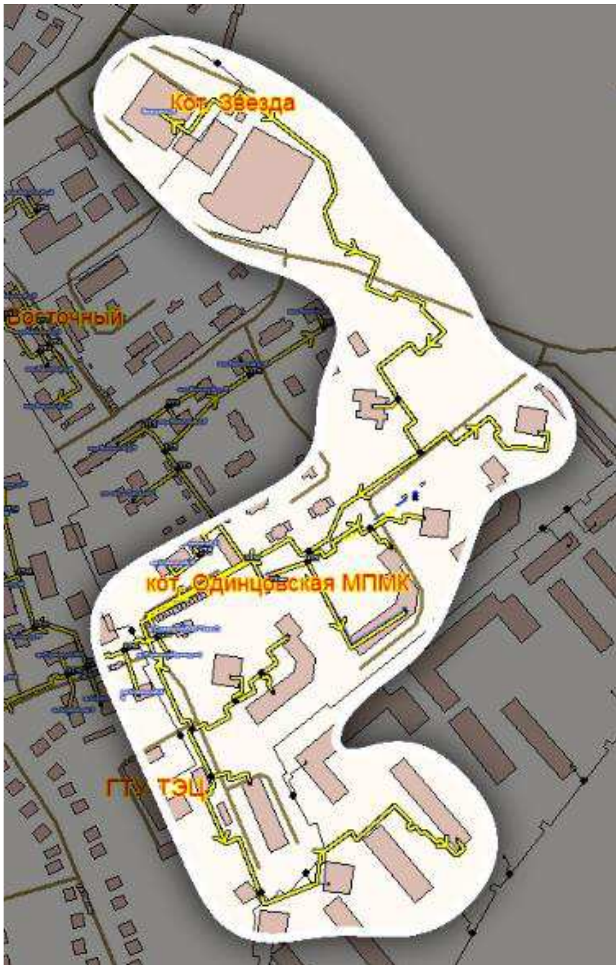
Рисунок 2.15 - Зона действия системы теплоснабжения котельной ФОК «Звезда»
