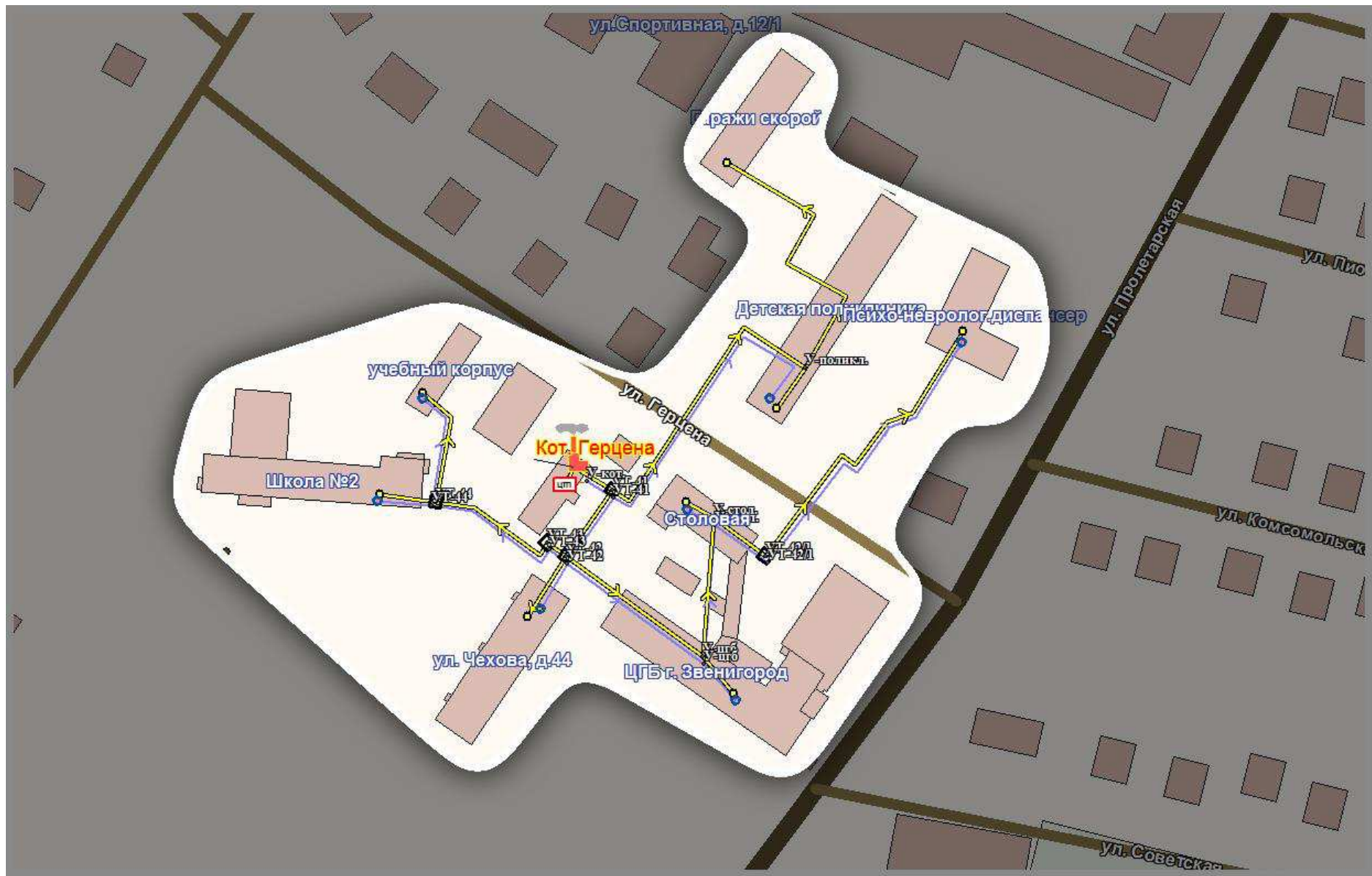
Рисунок 8.10 - Зона действия системы теплоснабжения котельной ул.Герцена,13А
