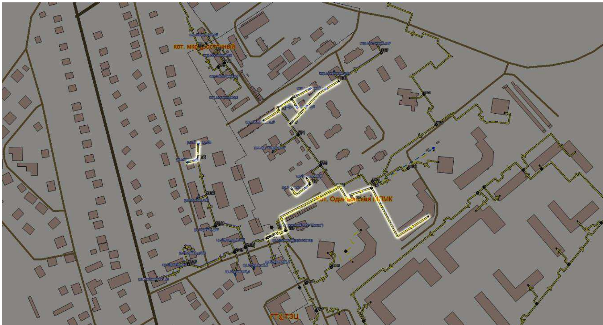
Рисунок 5.10 - Участки тепловой сети котельной Одицовская МГМК с завышенными удельными сопротивлениями
